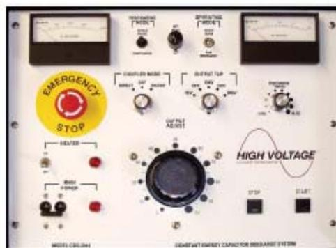
Unidades diseñadas para uso continuo, con fuente de AT tipo transformador convencional compensado. (No posee fuentes electrónicas de alta HF (osciladores de 50 kHz), que no permiten su uso confiable cuando se alimenta al sistema mediante grupos electrógenos, o ante fallas de difícil o extensa detección).
