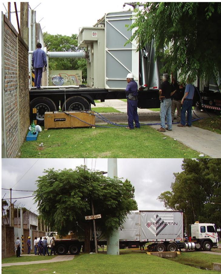
Ensayo de Tensión en CC 10kV. Este ensayo consiste en aplicar una tensión de 10kV CC durante un minuto sobre el conductor principal. No es un ensayo normalizado y su objeto es el de buscar errores groseros. Permite además verificar la correcta secuencia de fases.
