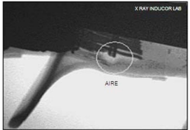
Oclusión de aire en terminal de 33kv
