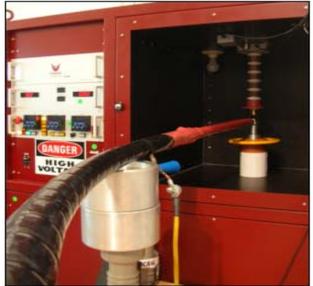
Cabina normalizada de ensayos de DP en terminales
