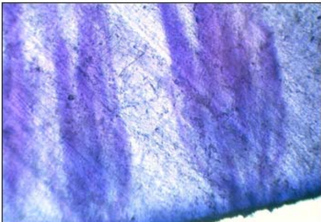
Imagen en microscopia digital 3D: Water- tree en semiconductor externa
