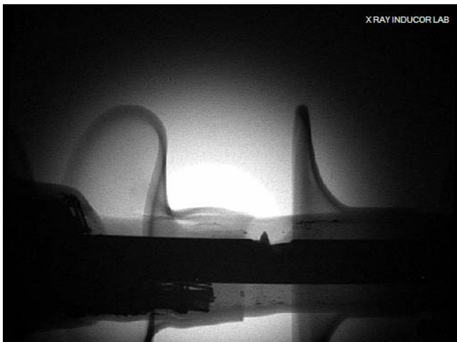
Imagen por Rayos X, terminal 33 KV
