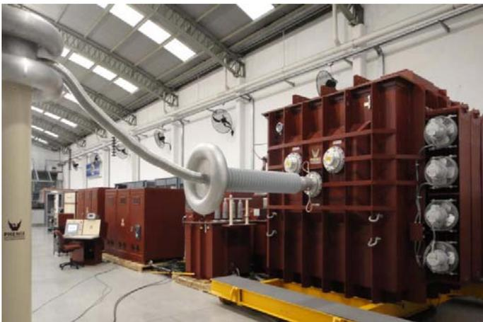
A la salida del reactor (RTS), un filtro de alta tensión tipo Pi, constituido por dos ramas capacitivas y tres ramas inductivas, que pueden operar a tensión plena, cumple dos importantes funciones:
