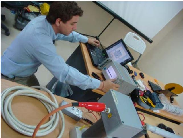
Una prueba irrefutable de esto, es que todas las normas para medición de descargas parciales, en transformadores, cables, máquinas, hablan siempre de: primero un tiempo o "intervalo de stress" (sobretensión a la que se somete a la muestra durante xxx minutos), y segundo, de un "intervalo de medición", a una tensión de prueba constante de xxx minutos.
