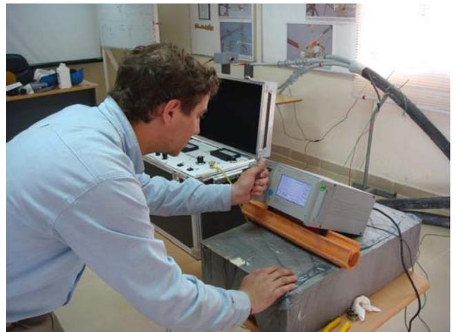
En contraposición al método DAC, si utilizáramos ahora una fuente del tipo VLF, en donde a 0.1Hz el radio de crecimiento de las ramificaciones de descargas (nivel de evolución de un defecto), es 5 veces mayor que el correspondiente a 50Hz, para una correcta aplicación (normalizada) de un ensayo de Tensión Resistida y luego uno de DP, el tiempo mínimo requerido de aplicación de la tensión de prueba, es una condición que debe ser cumplida rigurosamente.
